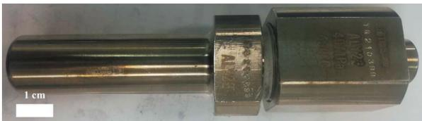
図4 密閉型反応容器
